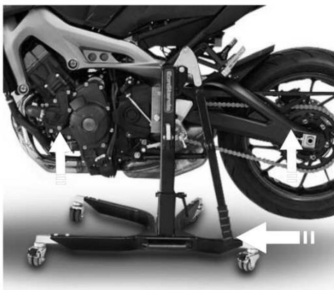
7. Drücken Sie den Hebelarm des Zentral-Montageständers so weit nach unten, bis die gewünschte Hubhöhe erreicht ist.
