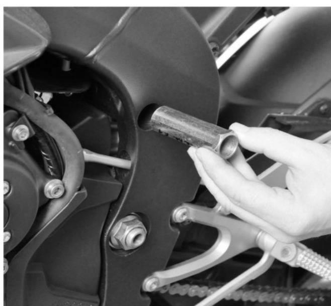
4. Setzen Sie die mitgelieferte Büchse in die Rahmenbohrung ein. Befestigen Sie sie mit 50 Nm (Richtwert).
