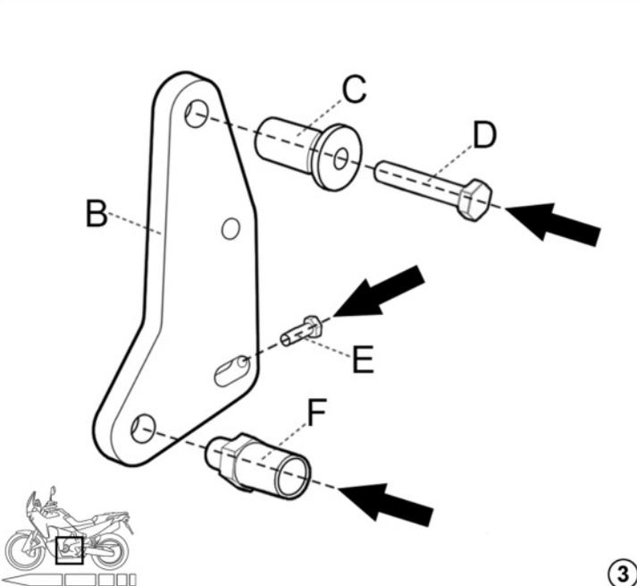
Die Schrauben und Unterlegscheiben zur Befestigung der Adapterplatte am Zentralständer sind ggf. im Lieferumfang des Zentralständers enthalten.
