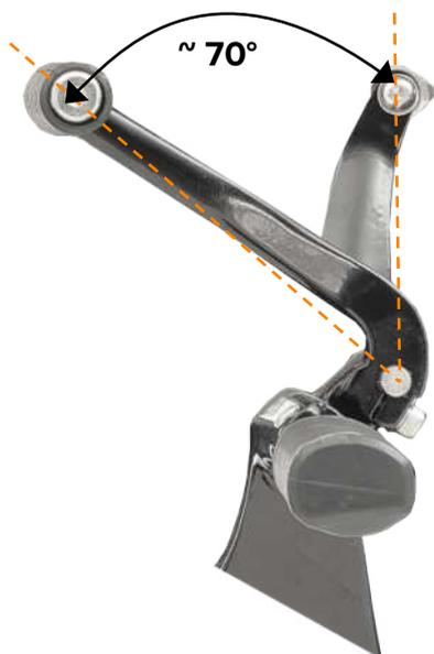
7. Monter le **pédale de vitesse (6)** sur le **levier de vitesse (5)**. Pour ce faire, utiliser la vis du **levier de changement de vitesse (7)** et du frein filet liquide.
