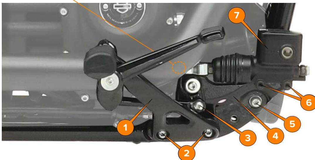
4. Desserrez les **vis d'origine (6)** et soutenez le **maître-cylindre de frein arrière (7)**.
