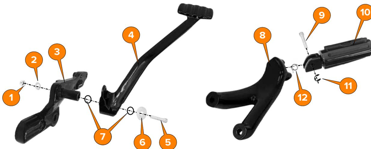
1. Coloque la primera **junta tórica (7)** en el **soporte del pedal de freno (3)**.
