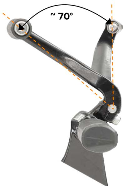
7. Montieren Sie den **Schaltraste (6)** am **Schalthebel (5)**. Nutzen Sie dazu die **Schaltrastenschraube (7)** und flüssige Schraubensicherung.
