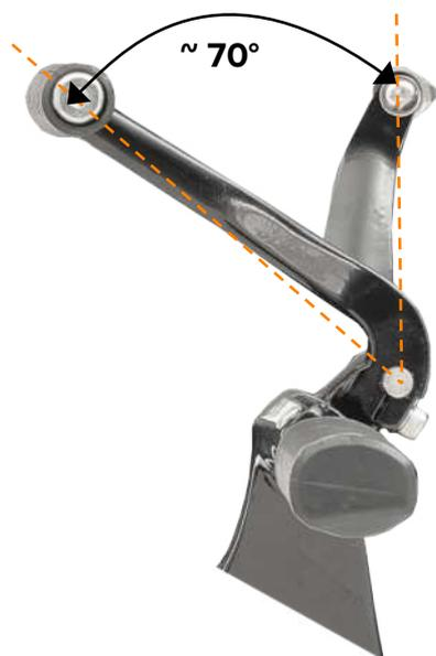
7. Montare il **fermo del cambio (6)** sulla **leva del cambio (5)**. A tale scopo, utilizzare la **vite del fermo del cambio (7)** e del frenafili liquido.
