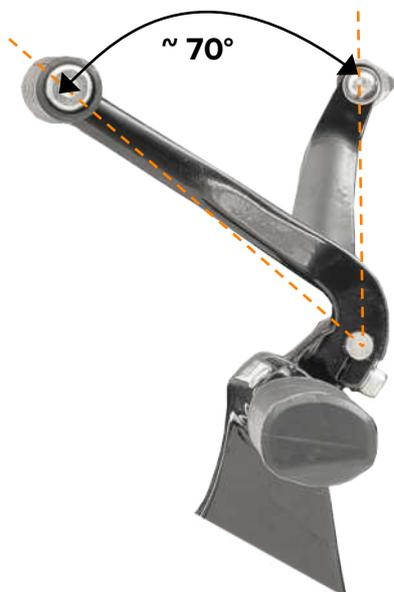
7. Monte el **retén de la palanca de cambios (6)** en la **palanca de cambios (5)**. Utilice para ello el **tornillo del retén de la palanca de cambios (7)** y líquido fijador de roscas.
