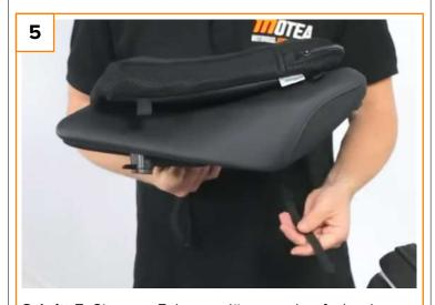
**Schritt 5:** Sitz vom Fahrzeug lösen und ggf. abnehmen.
