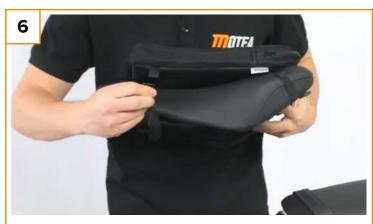
Schritt 6: Sitz vom Fahrzeug lösen, Befestigungsgurte um den Sitz führen und auf der anderen Seite des Sitzkissens in die Laschen einsetzen.
